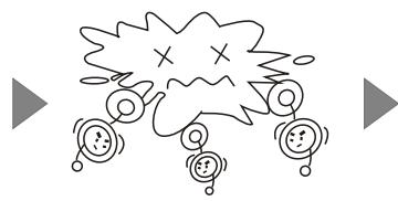
在超声波的作用下气泡会不断的“爆炸”冲击物体表面的污垢。
