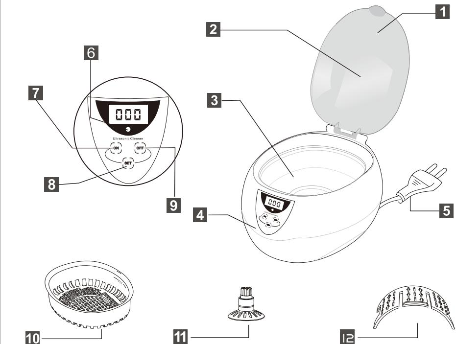
1 上盖 2 透视窗 3 不锈钢清洗槽 4 外壳 5 电源线 6 工作指示灯
