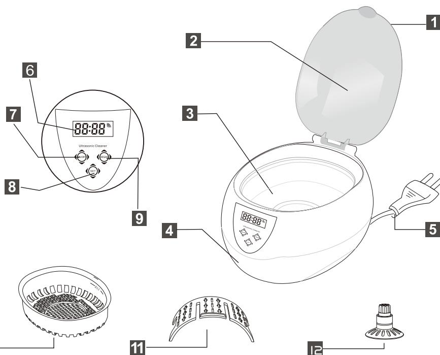
1 上盖 2 透视窗 3 不锈钢清洗槽 4 外壳 5 电源线 6 液晶显示屏
