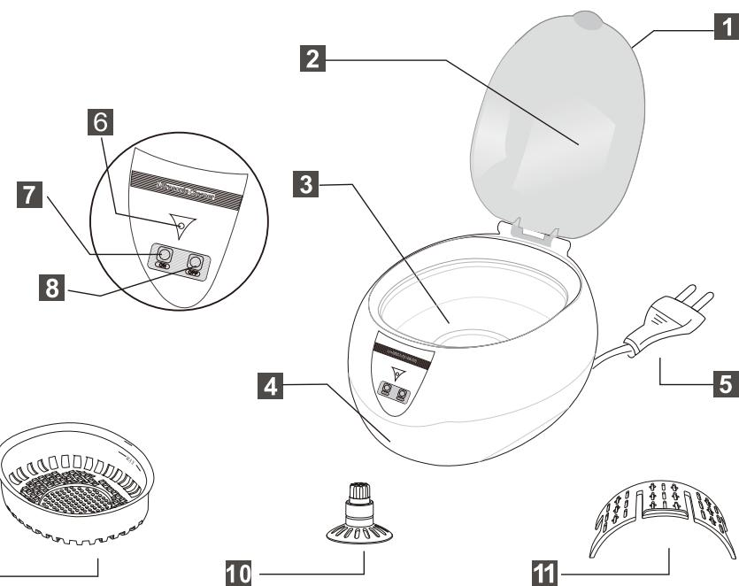
1 上盖 2 透视窗 3 不锈钢清洗槽 4 外壳 5 电源线 6 工作指示灯
